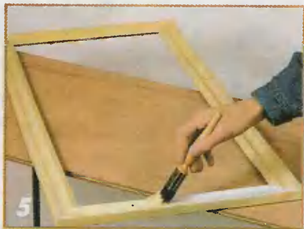
5 Загрунтовывают поверхности рамки. Покрывают их грунтовочной краской.
