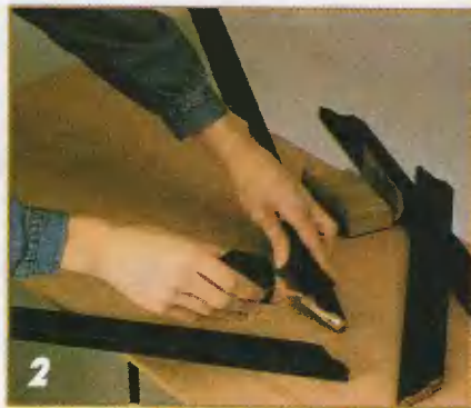
2 Наносят на эти торцы кромки клей ПВА.
