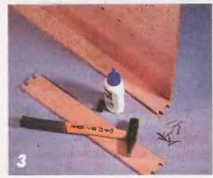
Собирают поднос на клею и гвоздиках.
