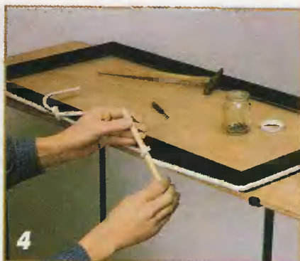
4 Скрепляют шнуром собранную рамку, натягивая его с помощью деревянного воротка.
