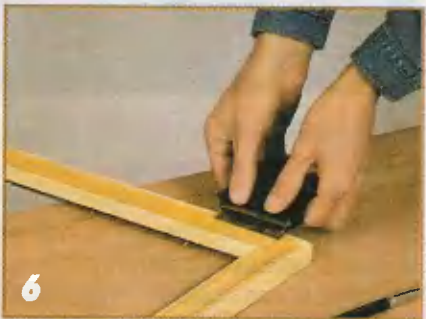
6 Аккуратно наносят узор на поверхность одной из деталей рамки, пользуясь специальным скребком.
