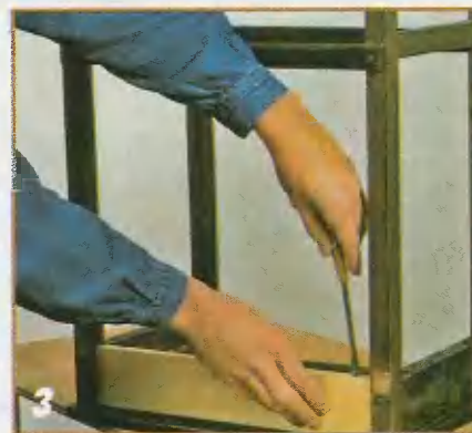
3 Устанавливают недостающую царгу.
