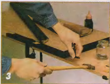
3 Соединяют детали между собой на клею и гвоздиках, заглубляя их шляпки.
