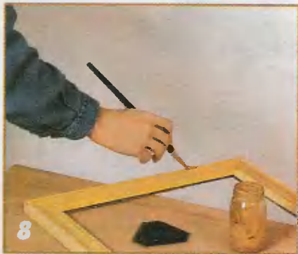
8 Покрывают все поверхности рамки лаком.
