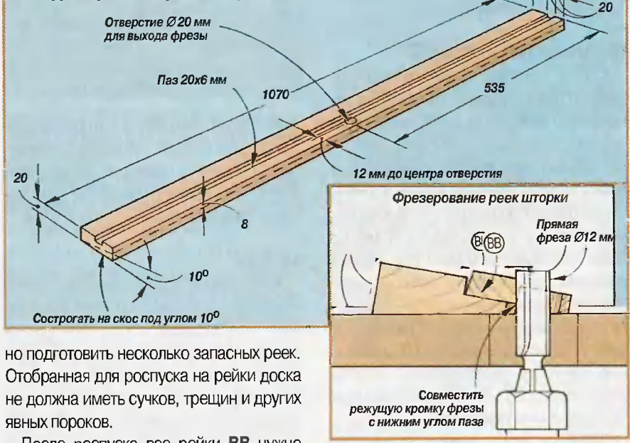
Рис. 7. Кондуктор для фрезерования реек шторки.
