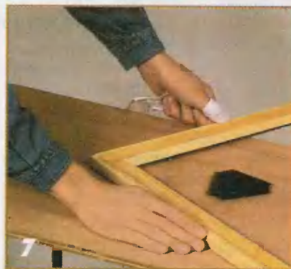
7 Зачищают кромки и стыки. Таким же способом наносят узор на противоположную деталь.
